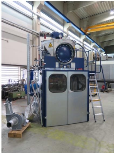
ROTOmAX 30 mit pneumatischem Ablasschieber, Rückstandsbehälter, Gewichtserfassung und geschlossener Tür (Isolierhaube für vorderen Mannlochdeckel demontiert)
